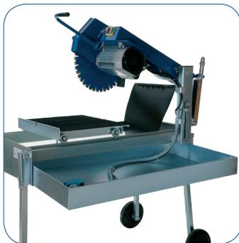
Seitlich ausziehbare Wasserwanne zur einfachen und schnellen Reinigung
